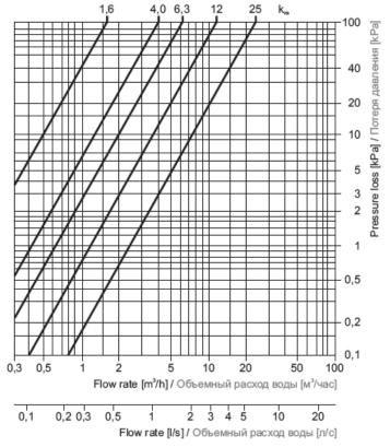
The  $k_{\infty}$  value indicates the flow through the valve in  $m^3$ /hour, with the valve in the fully open state, at the valve pressure loss of 100 kPa. Значение  $k_{\infty}$  приводит расход через клапан в  $m^3$ /час. при полном открывании и потере давления на клапане 100 кПа.
